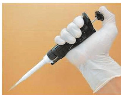
図7 マイクロピペッターの持ち方 (操作するときは垂直に持つ)
