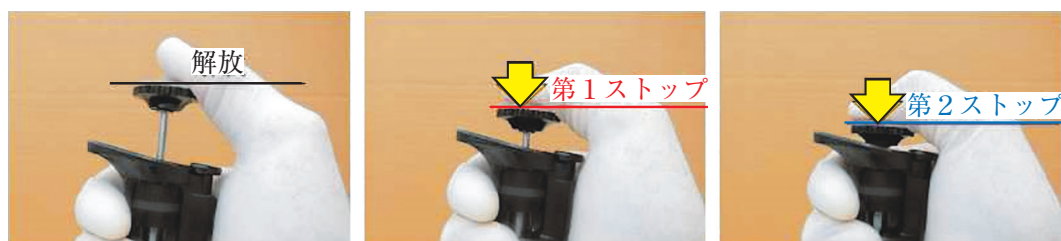
図9 マイクロピペッターの第1ストップと第2ストップ
