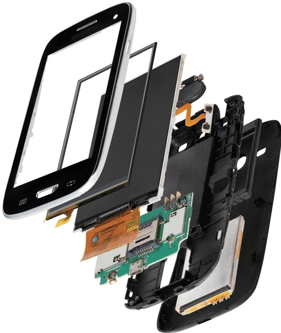
私たちが使っているスマートフォンには、歩数を計測するためなどに加速度センサーが入っています。このセンサーの位置を探してください。
