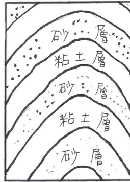
図 6 トンネル内部（天井）地層のスケッチ
