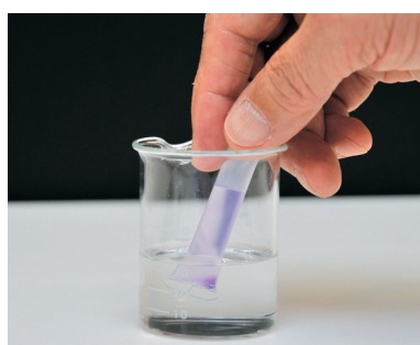
③そのまま②の状態、穴を検水の中に入れ、つまんだ指をゆるめ、半分くらい水を吸い込む。
