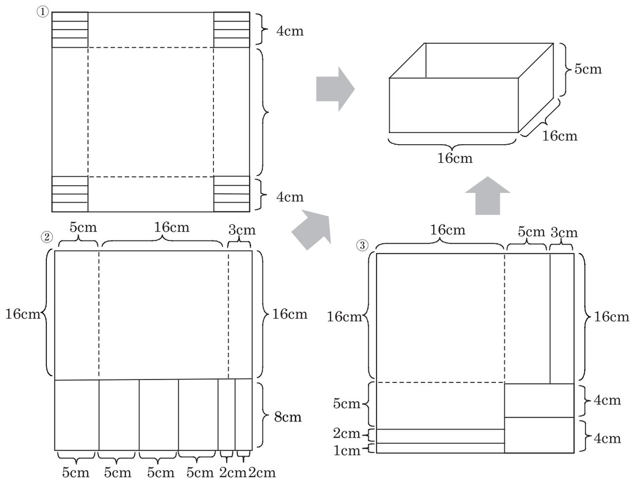
しかし、この立体は直方体の形状をした容器の中で最大のものではない。容積が最大となる直方体の形状は底面が正方形で、（底面の正方形の1辺）：（高さ）＝2：1のときである。24cm×24cmのシートでは、底面の正方形の1辺が $8\sqrt{3}$ cm、高さが $4\sqrt{3}$ cmのとき、最大容積は $768\sqrt{3}$ cm<sup>3</sup>で約1330.2cm<sup>3</sup>となる。ただし、展開図の作成についてはかなりの工夫が必要である。例えば、図2のような展開図が考えられる。
