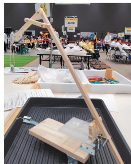
る中、この取り付けアームによって、支点からの距離をより長くすることができる反面、安定して飛行物体を飛ばすことが難しくなりますが、飛行物体の速さを上げることに成功していました。
