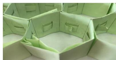
図5 編み込みによる補強
