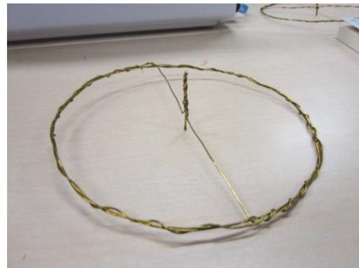
図7 重心を低くし、直径を大きくして慣性モーメントが大きくなるようにした独楽
