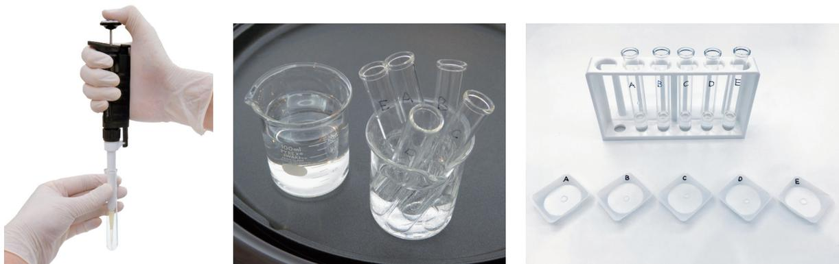
図8 加水分解の様子と溶液の取り分け
