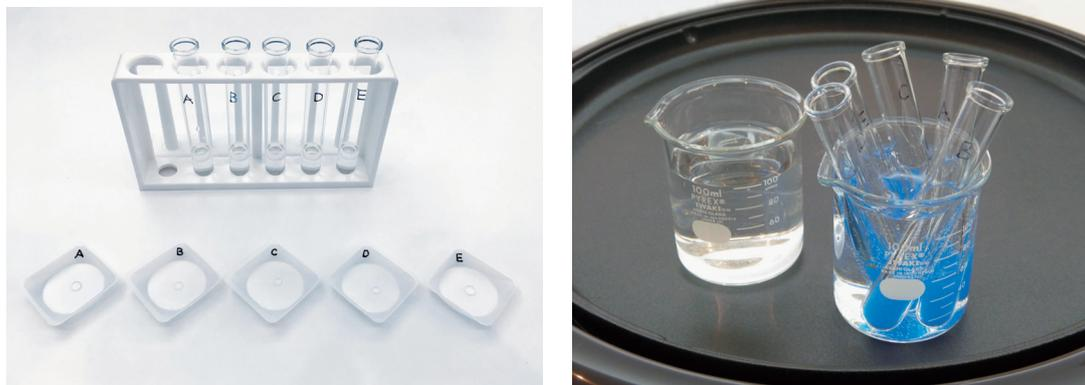
図9 希釈した糖類溶液(左)と溶液の加熱(右)
