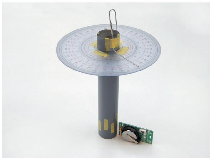
図6 完成した旋光度計
